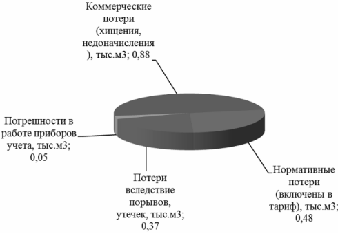
Рисунок 8 – Структурные составляющие потерь горячей воды при ее производстве и транспортировке
