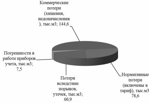
Рисунок 7 – Структурные составляющие потерь питьевой воды при ее производстве и транспортировке
