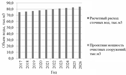
Рисунок 2 – Соотношение существующего и перспективного расхода сточных вод и мощности очистных сооружений
