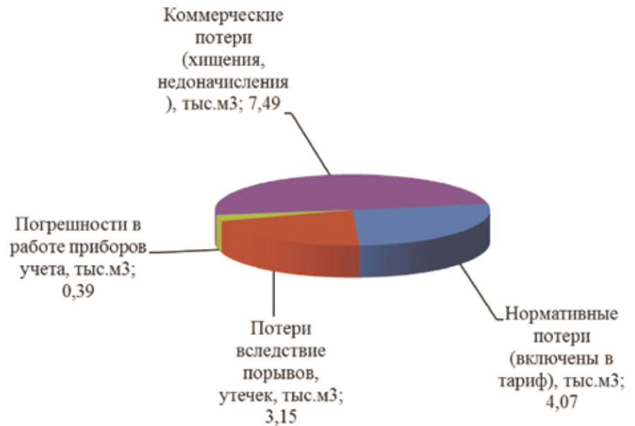
Рисунок 9 — Структурные составляющие потерь питьевой воды при ее производстве и транспортировке
