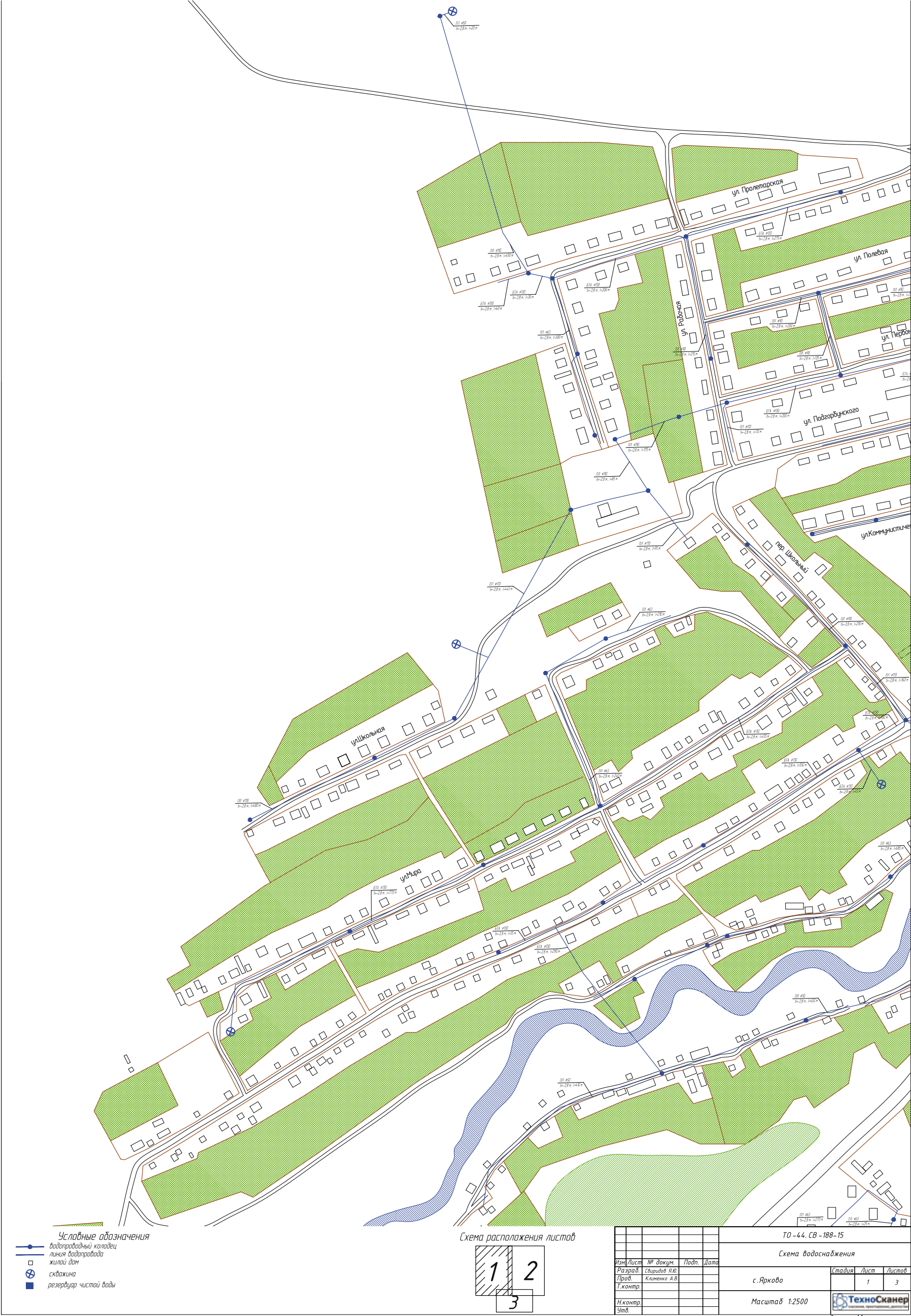
Приложение 1. Схемы водоснабжения и водоотведения
